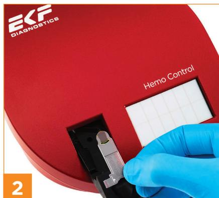
2 Mikroküvette in den Analyzer einsetzen
